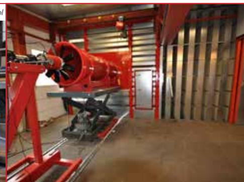
Испытательные мощности собственной разработки по стандартам ISO 5801 и 3741 Текущие проекты: новые высокоэффективные профили лопаток для осевых вентиляторов
